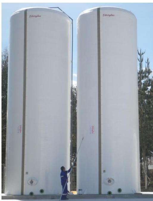
Otro de los sistemas empleados en la elaboración de depósitos es el de Proyección Simultánea, que consiste en proyectar al mismo tiempo la fibra de vidrio y la resina de poliéster.
